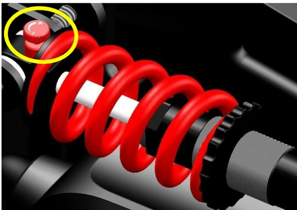
Ruotando la manopola rossa in senso orario, il movimento del pistone in uscita sarà più veloce. In questo modo si riduce lo smorzamento dell'unità ammortizzatore a molla.
