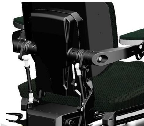
Fase 9: collegare entrambe le barre parallele e fissarle con il perno di bloccaggio. Fase 10: rimettere la copertura dello schienale sul telaio.
