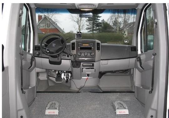
*Dahl docking station montata sul pavimento*
