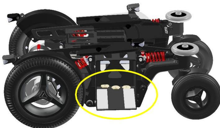
2. Due distanziali in plastica devono essere posizionati in ogni scatola della batteria sul pavimento. La cosa migliore è fissarli con del nastro biadesivo.
