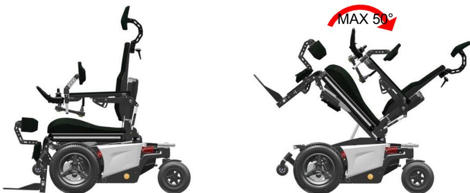
Se l'inclinazione viene attivata oltre un certo angolo, la velocità di guida viene ridotta. Questo per ridurre il rischio di pericolo durante la guida ad alta velocità.
