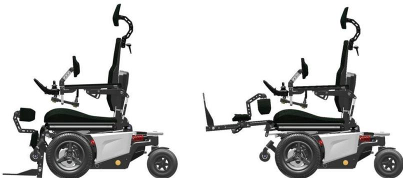
Se il poggiatesta viene allungato oltre i 45°, la velocità di guida viene automaticamente ridotta per motivi di sicurezza.
