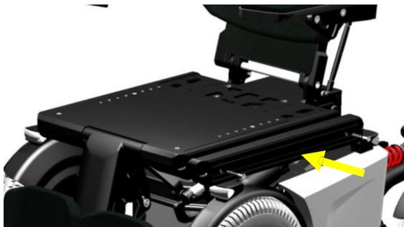
fase 4: posizionare la guida di prolunga e inserire il bullone di montaggio più lungo fornito con la guida di prolunga.
