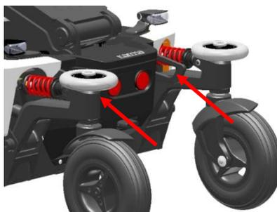
*occhielli di fissaggio nella parte posteriore*
