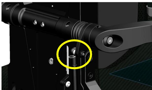
Fase 3: rimuovere il perno di bloccaggio della molla dal giunto sferico.
