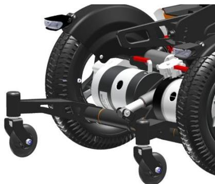
Le ruote di supporto impediscono alla carrozzina di ribaltarsi quando si sposta in posizione verticale. Le ruote di supporto sono posizionate davanti alle ruote motrici e vengono attivate automaticamente dal sistema elettronico. Le ruote di supporto sono obbligatorie in combinazione con un peso dell'utente a partire da 40 kg.
