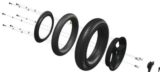
Dopo aver smontato le ruote della carrozzina, il cerchio può essere diviso. Il pneumatico è quindi disponibile per la riparazione. Le camere d'aria degli pneumatici possono essere riparate in base alla descrizione riportata sul kit di riparazione delle forature utilizzato. Si raccomanda tuttavia di rinnovare sempre la camera d'aria in caso di foratura.
