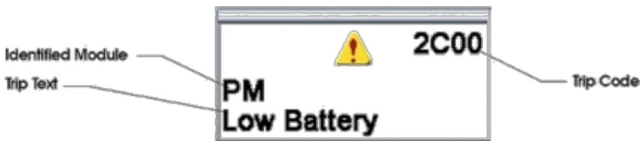
Questo indica un guasto del sistema, cioè R-net ha rilevato un problema nel sistema elettrico della carrozzina.
