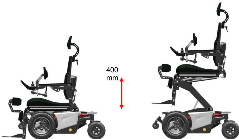
Quando si solleva il sedile, la velocità di guida si riduce automaticamente per ottenere sempre la massima stabilità. In posizione di seduta elevata, anche l'inclinazione del sedile viene bloccata per ottenere la massima stabilità. L'altezza del sedile può essere impostata dall'utente su qualsiasi posizione. L'altezza massima del sedile è impostata a 950 mm (piano del sedile a terra).
