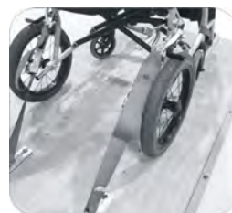
Einbau der hinteren Rückhalteeinrichtung
