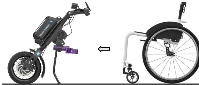
Abbildung 32 Schieben Sie den Rollstuhl an das Gerät
