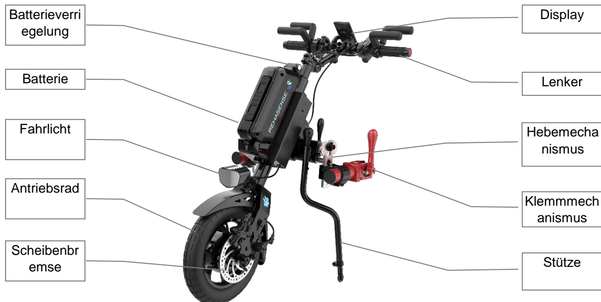
Abbildung 1 Hauptelemente des Geräts (Beispiel zeigt manuelle Konfiguration der Klemme und des Hebbers)
