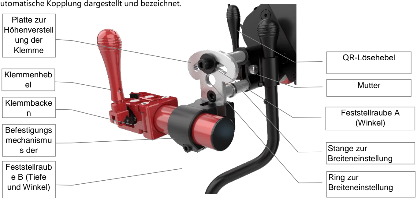
Abbildung 12 Baugruppen der manuellen Klemme und Breiteneinstellung
