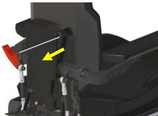
Schritt 1: Entfernen Sie die hintere Abdeckung der Rückenlehne. Dazu müssen Sie die 6 kleinen Schrauben mit einem 3 mm Inbusschlüssel lösen.
