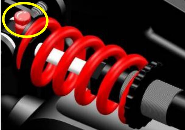
Durch Drehen des roten Knopfes im Uhrzeigersinn (in Richtung +) wird die Ausfahrbewegung des Kolbens wieder reduziert. Dadurch wird die Dämpfung der Federdämpfereinheit erhöht. Durch Drehen des Knopfes gegen den Uhrzeigersinn wird die Dämpfung verringert. Die richtige Einstellung wird durch Einstellen und Testen während der Fahrt vorgenommen.
