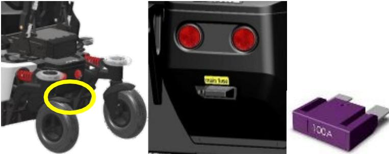
Position Hauptsicherung Hauptsicherung
