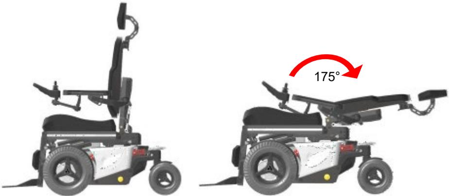
Bei einer zurückgelehnten Rückenlehnenposition über 135° wird die Fahrgeschwindigkeit aus Sicherheitsgründen automatisch reduziert.
