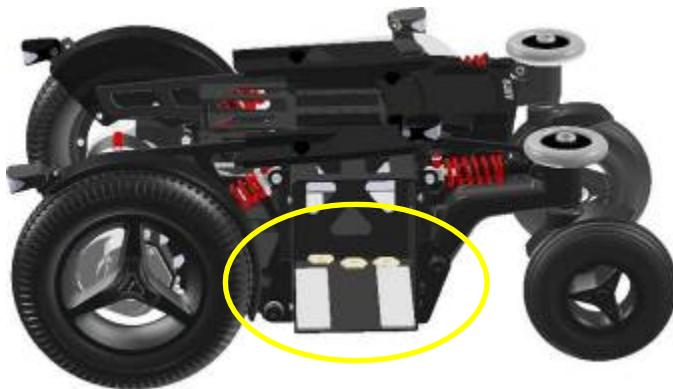
2. In jedem Batteriekasten auf dem Boden sind zwei Kunststoffabstandshalter zu platzieren. Am besten befestigen Sie sie mit doppelseitigem Klebeband.
