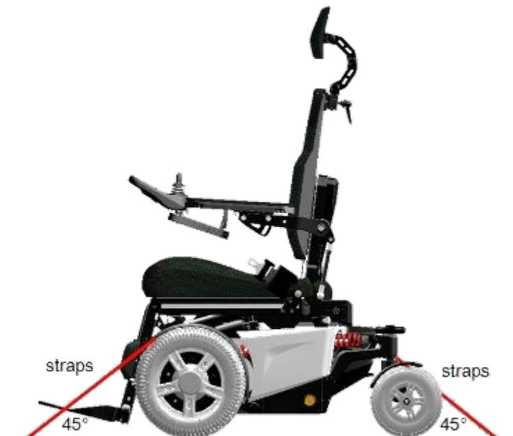
Die Gurte müssen an geeigneten Verankerungspunkten mit dem Fahrzeug verbunden sein. Stellen Sie sicher, dass der Reifendruck dem empfohlenen Wert entspricht, damit die Gurte ihre maximale Wirkung entfalten können.
