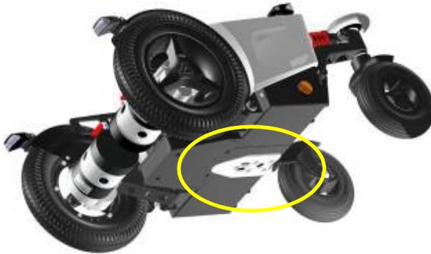
*EVO-Gehäuse mit montierter Dahl-Dockingplatte.*
