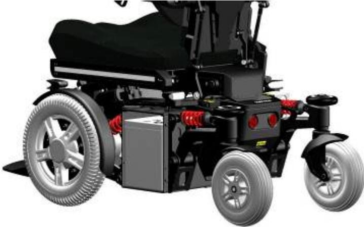
*Position und Zugang zu den wartungsfreien Batterien*
