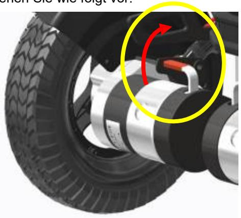
Um die Bremsen zu blockieren, bewegen Sie den Hebel in die Position "blockieren" an beiden Motoren.
