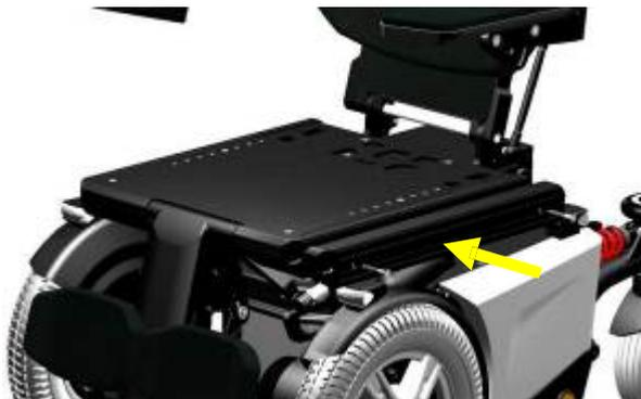
Schritt 4: Bringen Sie die Verlängerungsschiene in Position und setzen Sie die längere Befestigungsschraube ein, die mit der Verlängerungsschiene geliefert wird.
