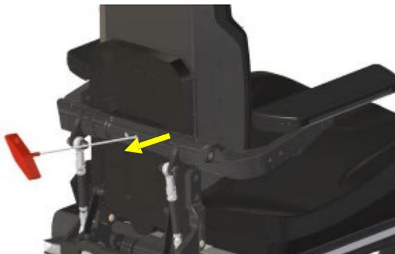
Schritt 2: Lösen und entfernen Sie die beiden Schrauben mit einem 5 mm Inbusschlüssel.
