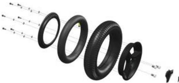
Nachdem die Räder des Rollstuhls abgenommen wurden, kann die Felge geteilt werden. Der Reifen ist dann für die Reparatur verfügbar. Die Schläuche der Reifen können entsprechend der Beschreibung auf dem von Ihnen verwendeten Reifenreparaturset repariert werden. Es wird jedoch empfohlen, den Schlauch immer zu erneuern, wenn der Schlauch eine
