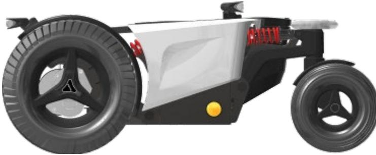
Jedes der Vorderräder wird von einem leistungsstarken Antriebsmotor angetrieben. Diese Motoren sorgen auch für die Lenkung des Rollstuhls. Mit diesem System ist es möglich, auf der Stelle zu drehen. Das macht den Rollstuhl optimal für den Einsatz in Innenräumen.
