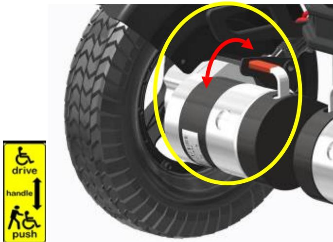
*Prüfung der Bremslüftung*
