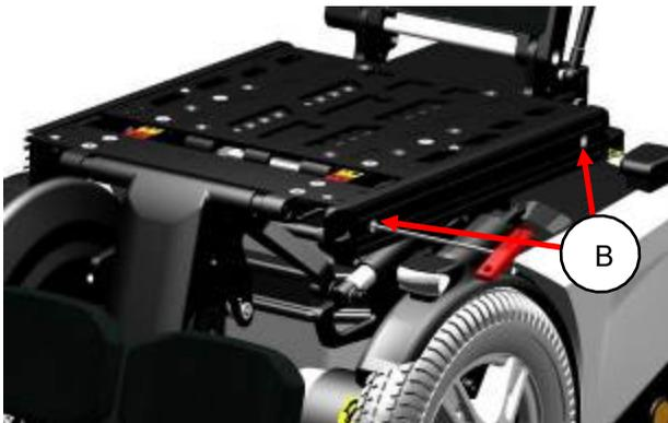
Schritt 4: Lösen Sie die Schrauben (B) der Seitenschiene mit einem Inbusschlüssel der Größe 4mm.
