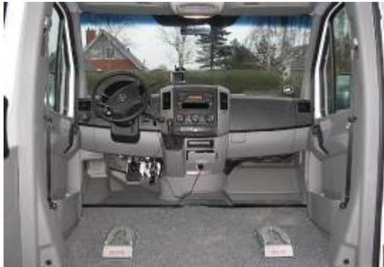
*Dahl Docking Station auf dem Boden montiert*
