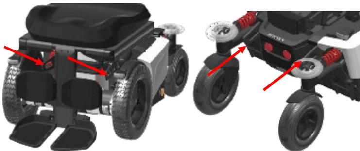
*Befestigungsschlaufen an der Vorderseite* *Fixierungsschlaufen an der Rückseite*
