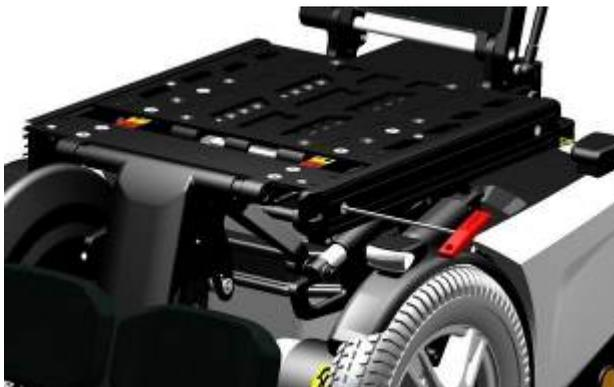
Schritt 8: Bringen Sie die Seitenschienen an und ziehen Sie die Schrauben fest.
