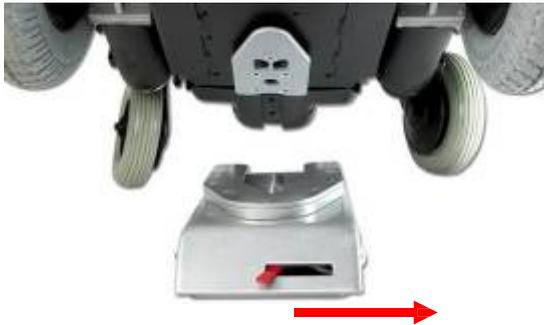
Um die Dockingstation manuell zu entriegeln, muss der rote Hebel nach rechts gezogen werden. Dadurch wird der Verriegelungsbolzen manuell zurückgezogen, so dass der Rollstuhl aus der Docking-Station entriegelt werden kann.
