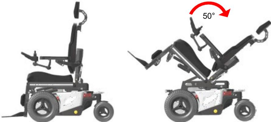
Wenn die Neigung über einen bestimmten Winkel hinaus aktiviert wird, wird die Fahrgeschwindigkeit reduziert. Dies dient dazu, das Gefahrenrisiko beim Fahren mit hoher Geschwindigkeit zu verringern.
