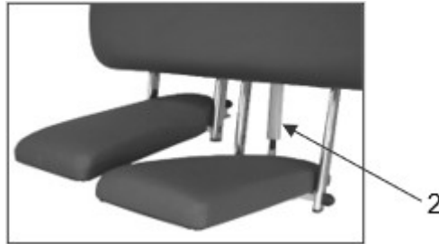
Figura 10: Cilindro di regolazione per la regolazione della pedana
