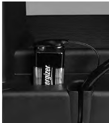
Pile 9 V pour l'abaissement d'urgence
