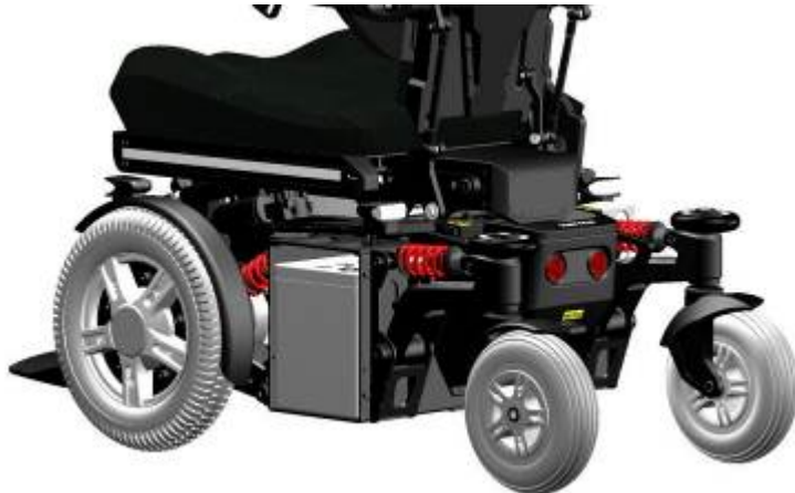
Position et accès aux batteries sans entretien
