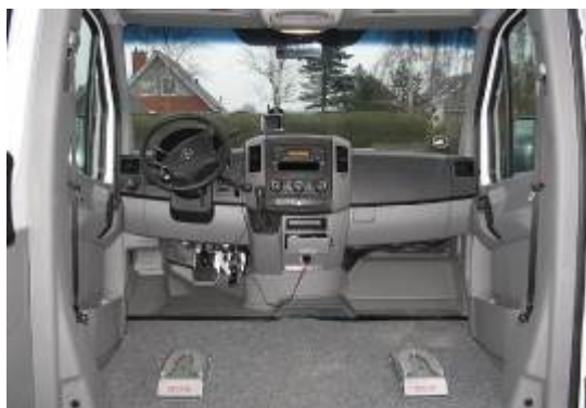
Station d'accueil Dahl montée au sol
