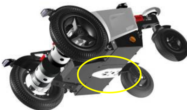
Châssis EVO avec plaque d'accueil Dahl montée.
