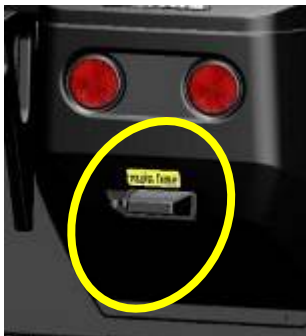
Emplacement du fusible principal / Fusible principal
