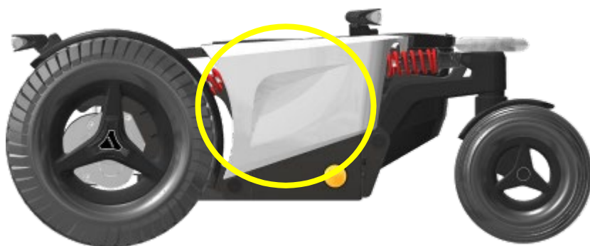
Le boîtier de batterie
