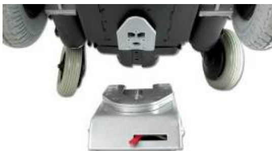
Station d'accueil et plaque d'accueil sur le châssis
