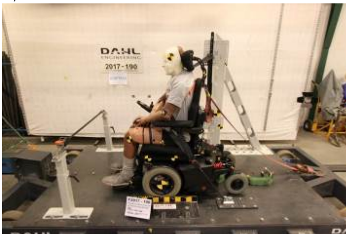
Test de collision EVO Lectus utilisant la station d'accueil Dahl.
