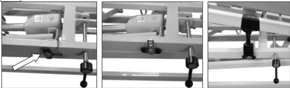
Figura 20: Procedura per fissare la superficie di appoggio contro il ribaltamento
