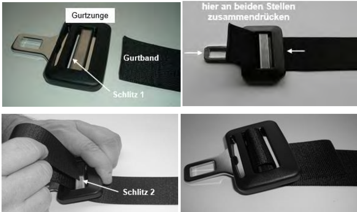
Abbildung 13: Vorgehen beim Einschlaufen des Gurtbands
