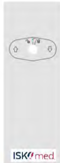
Abbildung 5: 1-reihiger Handschalter (1. Tastenreihe: Höhenverstellung)
