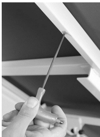
Abbildung 2: Abschrauben der Liegefläche
