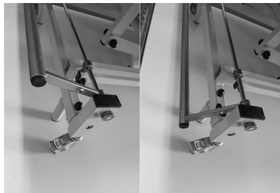
Figura 11: Funzionamento del sistema di sollevamento a rulli
