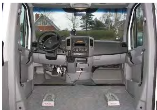
Dahl docking station montata sul pavimento
