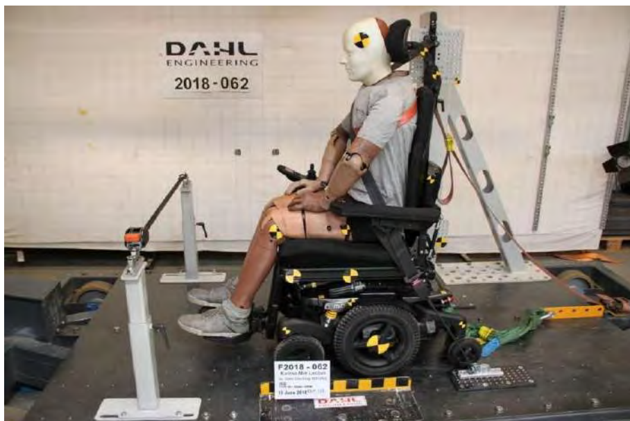
Test d'urto di Mid Lectus con la docking station Dahl
