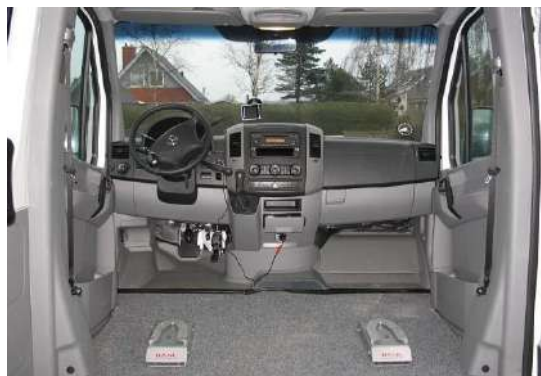
Dahl Docking Station auf dem Boden montiert
