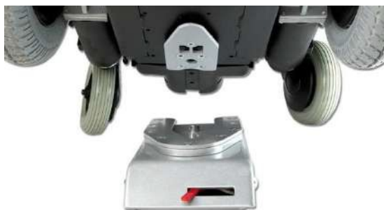
Dockingstation und Dockingplatte am Fahrgestell
