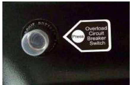
Position des Schutzschalters Druckknopf des Schutzschalters
