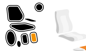
Figure 5.22. Symbole de l'ajustement de la longueur du repose-jambes avec compensation de longueur.
