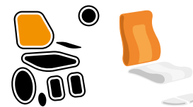
Figure 5.19. Symboles du dispositif d'escamotage du dossier électrique.
