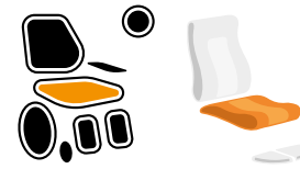
Figure 5.17. Symboles du réglage électrique de la hauteur.
