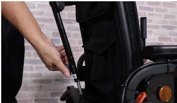
*Poussez le levier d'inclinaison du siège à harnais.*
