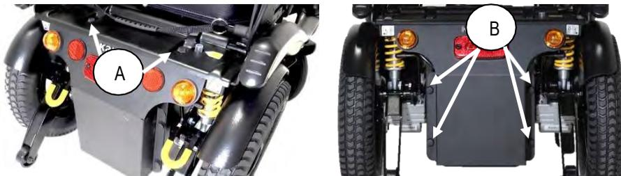
Après avoir enlevé le couvercle, la batterie sans entretien peut être sortie de la boîte. Attention aux câbles ! Lors de l'installation de la batterie sans entretien, il faut faire très attention à ce que les câbles ne soient pas coincés entre la batterie et le boîtier.
