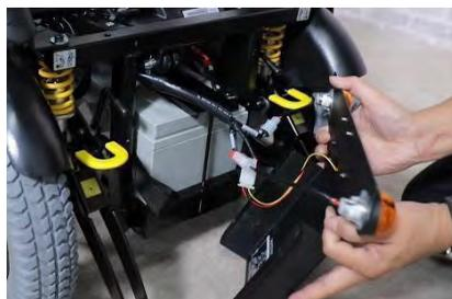
étape 7. Desserrez ces 4 boutons des deux côtés pour retirer le couvercle arrière.
