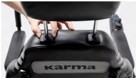
Réglez la hauteur de l'appui-tête à partir de ce bouton situé sous l'appui-tête.
