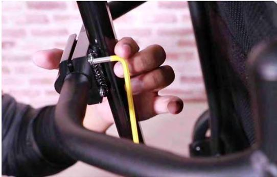
étape 1 : Utilisez une clé Allen de 4 mm pour régler la position horizontale du support reliant l'appui-tête au cadre.
