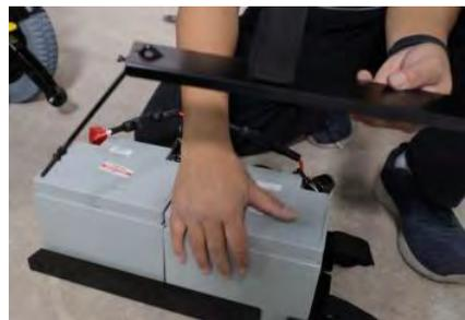
étape10. Utilisez une clé ouverte de 8 mm pour desserrer ce boulon.
