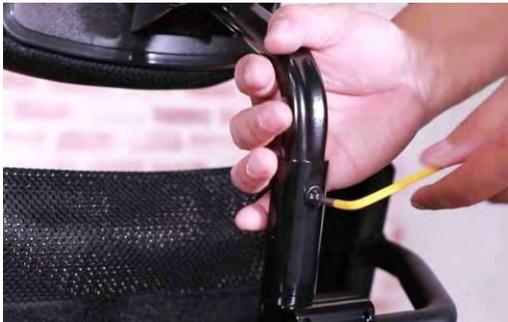
étape 2 : Utilisez une clé Allen de 4 mm pour régler la hauteur du cadre de l'appui-tête.
