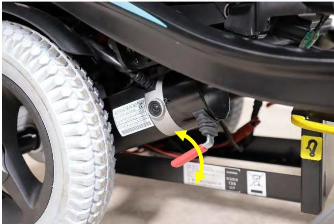
*Essai du dispositif de desserrage des freins*
