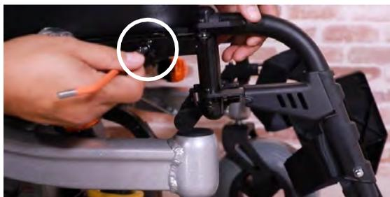
Étape 1 : utilisez la clé Allen de 5 mm incluse dans votre kit d'outils KARMA pour retirer les vis sous le siège.
