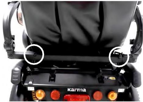
étape 1 : Utilisez une clé Allen de 5 mm pour dévisser les vis de fixation des accoudoirs.
