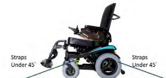
L'angle des sangles doit être d'environ 45° par rapport au plan horizontal. Ceci afin d'obtenir un effet maximal dans les directions verticale et horizontale.
