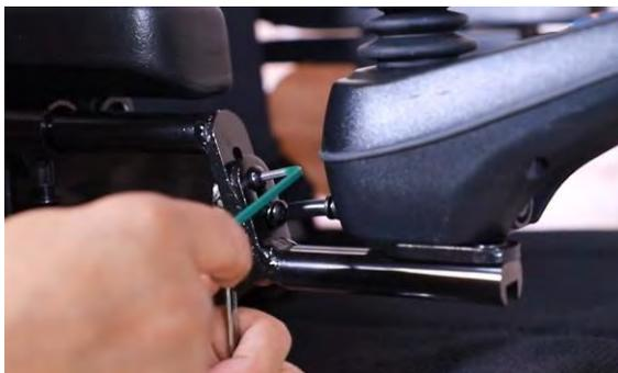
étape 1 : Utilisez une clé Allen de 3 mm et une clé ouverte de 8 mm pour desserrer ce boulon. étape 2 : Après avoir confirmé la position, resserrez la vis.
