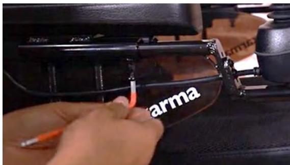
étape 1 : Utilisez une clé Allen de 5 mm pour desserrer ce boulon.
