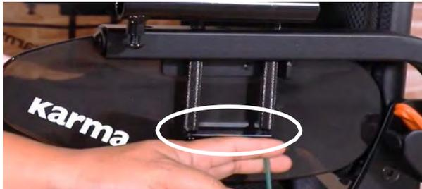
étape 1 : Utilisez une clé Allen de 3 mm pour retirer les deux vis indiquées ci-dessus.
