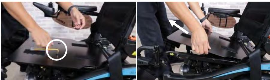
étape 4. Utilisez une clé Allen de 4 mm pour dévisser le boulon reliant la plaque de siège et retirer la plaque de siège. Lorsque vous retirez la plaque de siège, inclinez-la d'abord vers le haut, puis tirez.
