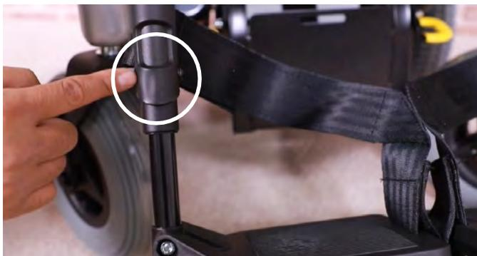
Utilisez la clé ouverte de 10 mm et la clé Allen de 5 mm du kit d'outils KARMA pour desserrer le boulon situé sur le côté du repose-pieds, ajustez la hauteur du repose-pieds et resserrez le boulon. Les repose-pieds sont maintenant réglés dans une position différente.
