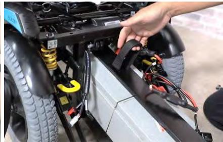
étape 9. Utilisez les sangles arrière et avant pour retirer la plaque de la batterie.
