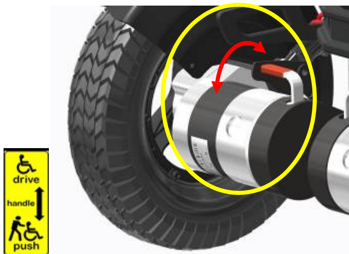
Prova dello sblocco del freno
