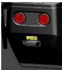
Posizione del fusibile principale
