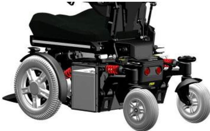
Posizione e accesso delle batterie senza manutenzione
