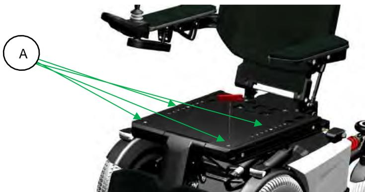
Schritt 2: Lösen Sie die Schrauben der oberen Sitzplatte (A) mit einem 4-mm-Inbusschlüssel. Schritt 3: Nehmen Sie die obere Sitzplatte ab.
