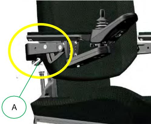
Schritt 1: Lösen Sie die Verriegelungsbolzen (A) auf jeder Seite der Armlehne mit einem Inbusschlüssel der Größe 5 mm.
