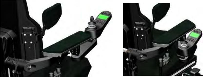
*Seitenlenkungssteuerung* Seitenlenkung, wegschwenkbar
