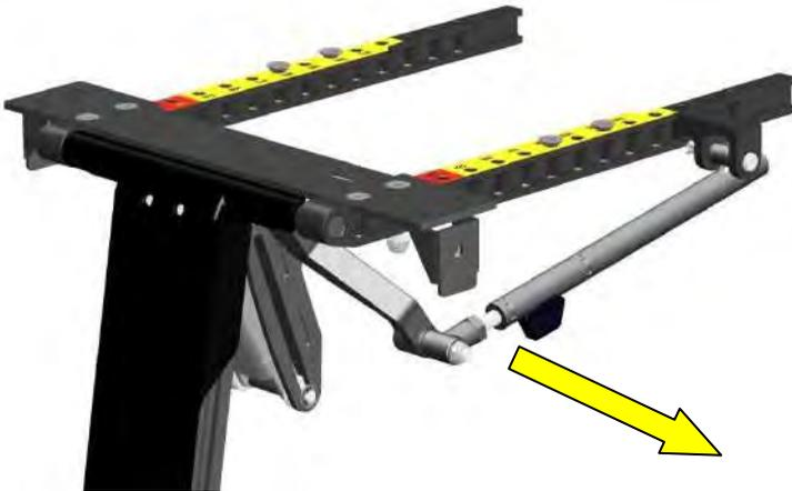
Schritt 1: Ziehen Sie die eingekreiste Hebelplatte gerade so weit, dass sich die Beinstütze verschieben lässt.
