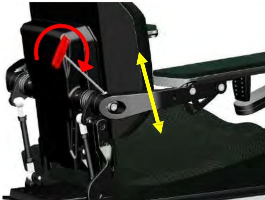
Schritt 2: Stellen Sie den Winkel der Armlehne mit einem 5 mm Inbusschlüssel ein. Durch Drehen im Uhrzeigersinn wird die Höhe der Armlehne erhöht. Durch Drehen gegen den Uhrzeigersinn wird die Höhe der Armlehne verringert.
