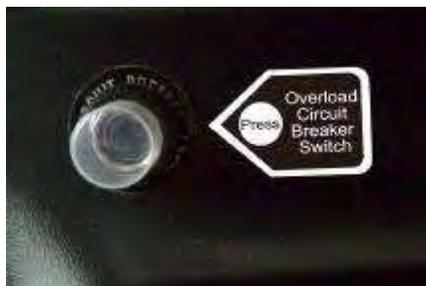
*Position des Schutzschalters Druckknopf des Schutzschalters*
