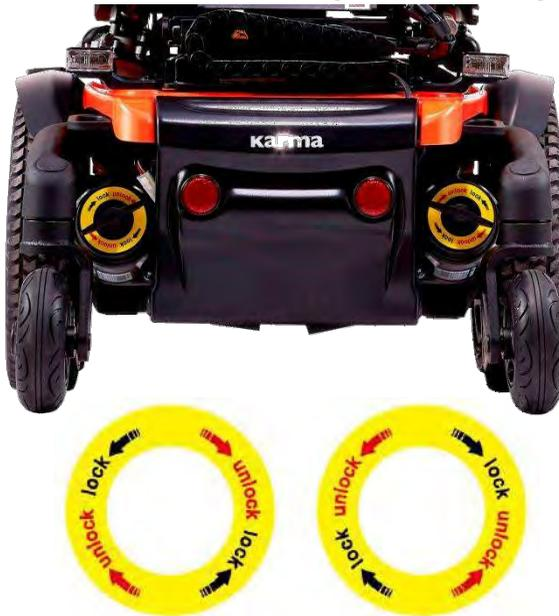
Achten Sie auf den schwarzen Hebel an jedem der Antriebsmotoren, der an der Rückseite des Fahrgestells befestigt ist.
