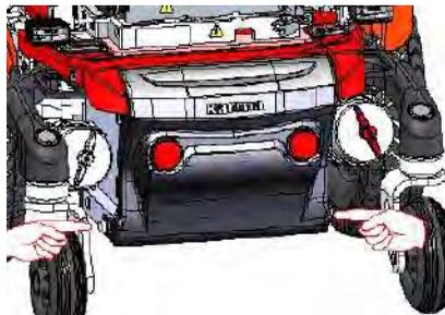
Schritt 4. Klappen Sie die Kunststoffabdeckung hoch, um den Klettverschluss zu lösen. Lösen Sie die hinteren Abdeckungen.
