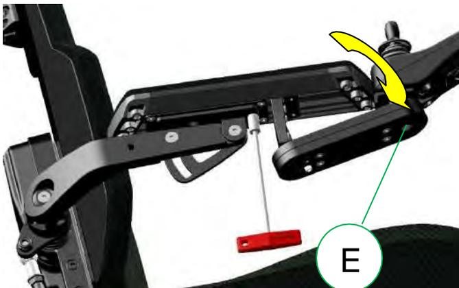
Schritt 1: Lösen Sie die Mutter (E) unterhalb des Armlehnenpolsters mit einem 10-mm-Schlüsselkopf.
