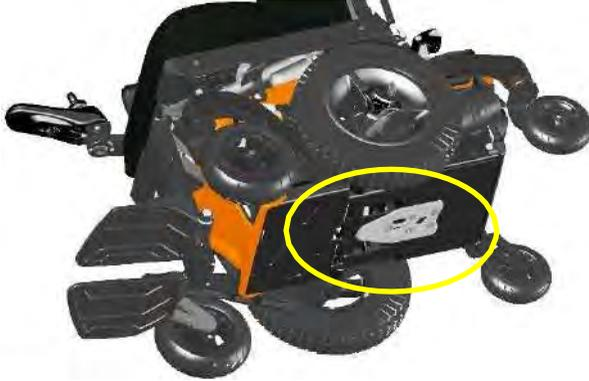
*MID-Gehäuse mit montierter Dahl-Dockingplatte.*
