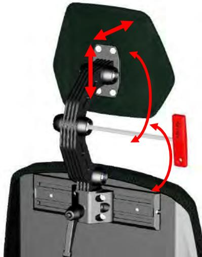
Schritt 2: Lösen Sie die Schrauben mit einem 6-mm-Inbusschlüssel. Lösen Sie sie, bis sich die Kopfstütze bewegen lässt.
