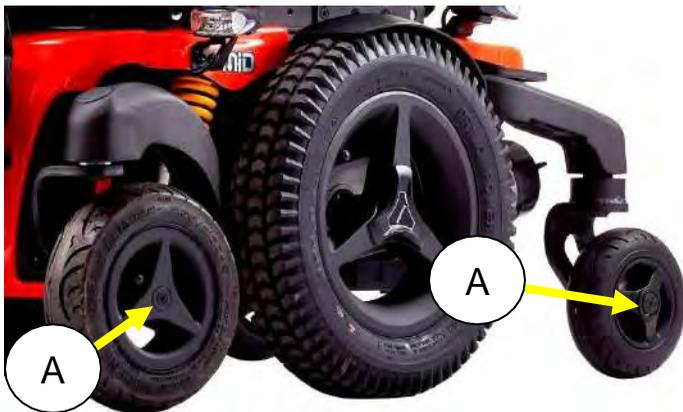
Die vorderen und hinteren Räder müssen von der Achse abgenommen werden, indem die mittlere Schraube (A) gelöst wird.
