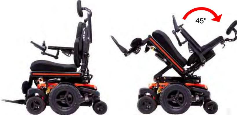
Wenn die Neigung über einen bestimmten Winkel hinaus aktiviert wird, wird die Fahrgeschwindigkeit reduziert. Dies dient dazu, das Risiko einer Gefährdung beim Fahren mit hoher Geschwindigkeit zu verringern.
