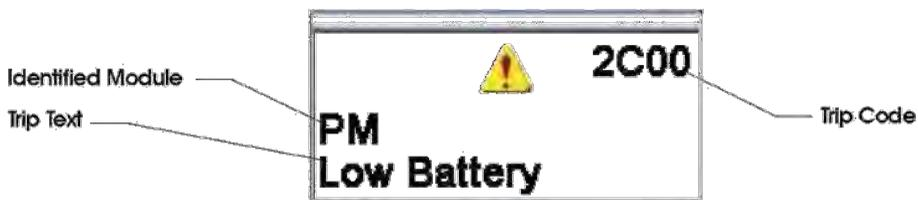
Dies weist auf einen Systemfehler hin, d. h. R-net hat ein Problem irgendwo in das elektrische System des Rollstuhls.
