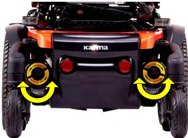
*Prüfung der Bremslüftung*
