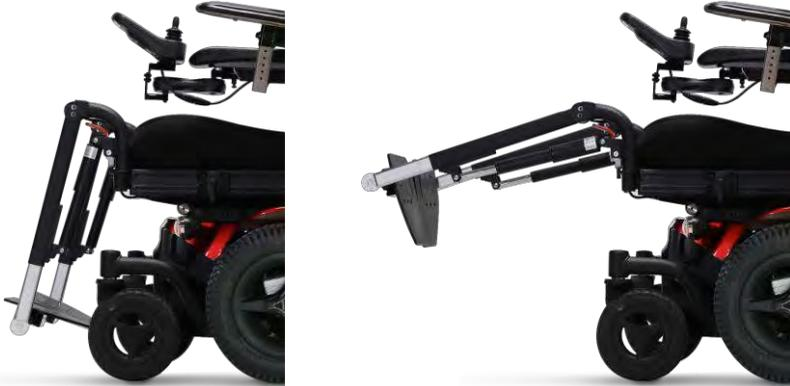
Wenn die Beinstütze über 45° gestreckt ist, wird die Fahrgeschwindigkeit aus Sicherheitsgründen automatisch reduziert.
