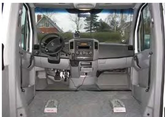
*Dahl Docking Station auf dem Boden montiert*
