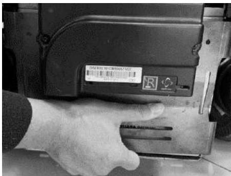
Schritt 8. Klemmen Sie das Batteriekabel ab und nehmen Sie dann die Batterie vollständig heraus, um den Plus- und Minuspol zu lösen. Tauschen Sie die Batterien aus.
