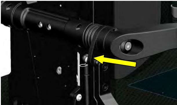
Schritt 4: Lösen Sie die Parallelschiene (B) von der Armlehne.
