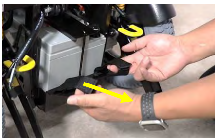
passo 9. Utilizzare la cinghia posteriore e anteriore per estrarre la piastra della batteria
