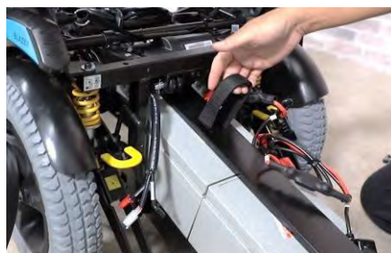
passo 9. Utilizzare la cinghia posteriore e anteriore per estrarre la piastra della batteria
