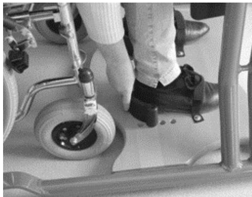
Figura 5: Regolazione degli interruttori del tallone e del fissaggio della punta del piede
