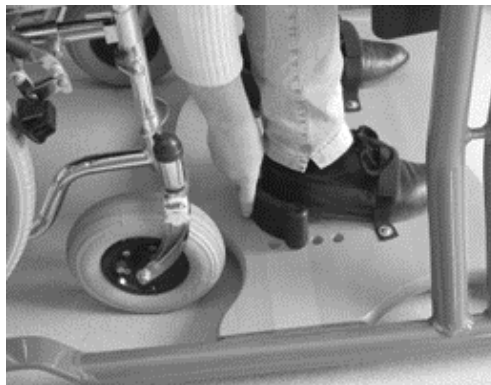
Abbildung 5: Einstellung der Fersenschalen und Zehenfixierung
