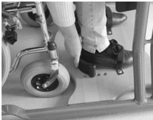
Figure 5 : Réglage de la talonnette et de la fixation des orteils
