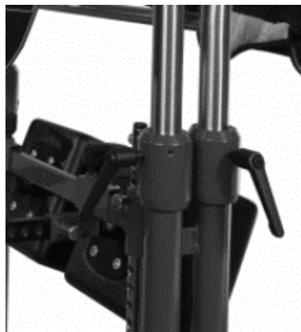
Abbildung 3: Klemmhebel zur Tischhöhenverstellung
