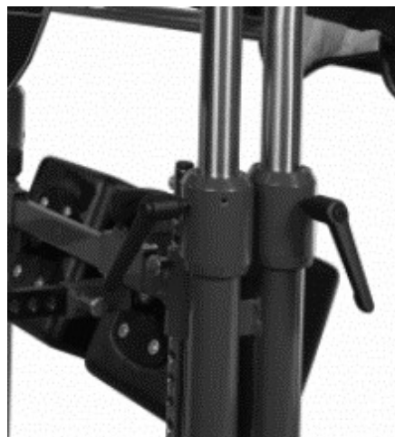
Figure 3 : Levier de serrage pour le réglage de la hauteur de la table
