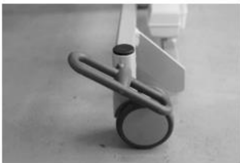
Abbildung 7: Rollen in gebremsten und ungebremsten Zustand
