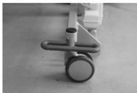
Figura 7: Ruote in condizioni frenate e non frenate
