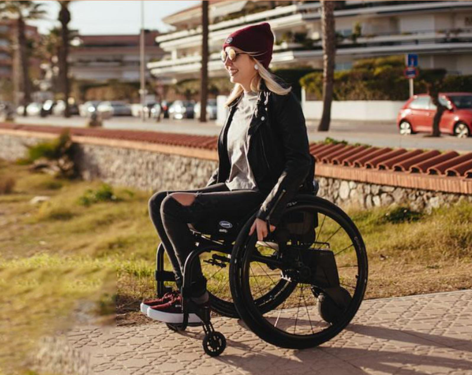
Der SMOOV one ist ein innovativer Elektroantrieb, den man jederzeit flexibel an den Rollstuhl an- und abdocken kann. Wann immer man ihn braucht. Und sogar während man im Rollstuhl sitzt. Dank des hochwertigen Materials und einem Gewicht von 7,2 kg ist der Elektroantrieb leicht genug für den Alltag – und trotzdem robust.
