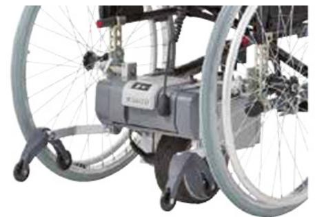
Kippstützen -Verhindern das Überkippen -Für das Befahren von Steigungen über 8 Prozent -Mit automatischer Wegschwenk-Funktion für das Überqueren von Bordsteinen und Absätzen -Per Schnellverschluss abnehmbar
