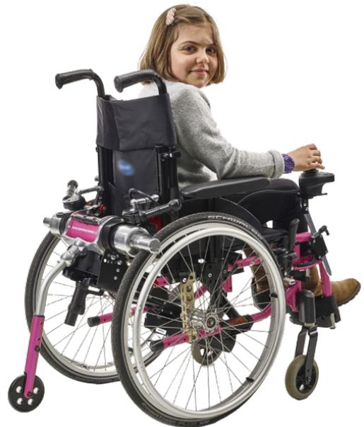
Der Light Drive 2<sup>1</sup> ist modular aufgebaut und kann an verschiedene Rollstühle angepasst werden (Wachstum des Kindes, Wechsel des Rollstuhltyps).
