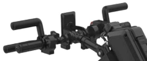
Mit dem Tetragasgriff kann der PAWS auch mit wenig Handfunktionen bedient werden. Dies gilt sowohl für die Beschleunigung wie auch für den Bremsvorgang.
