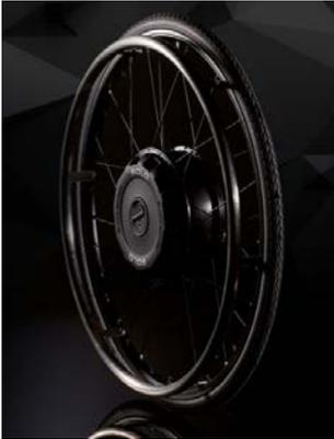
In den Rädern diskret verpackt. Die kräftigen Antriebsmotoren des SOLO.
