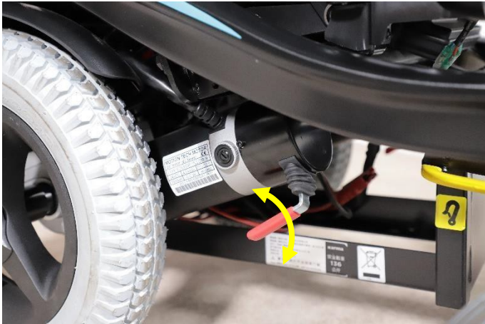
Prüfung der Bremslüftung
