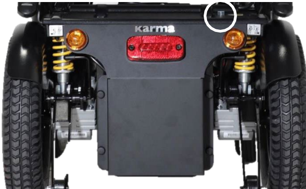
Standort des Leistungsschalters
