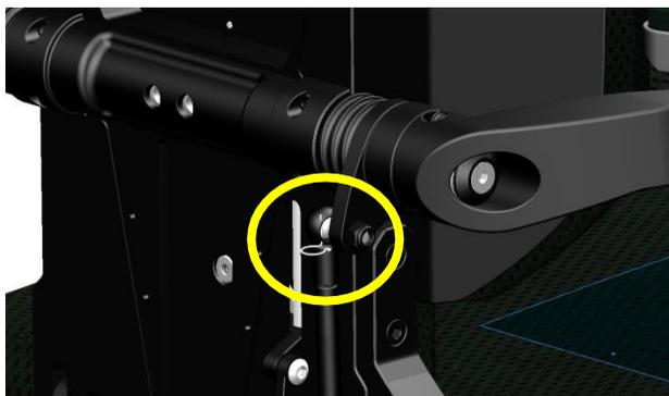
Schritt 3: Entfernen Sie den Federsicherungsstift aus dem Kugelgelenk.
