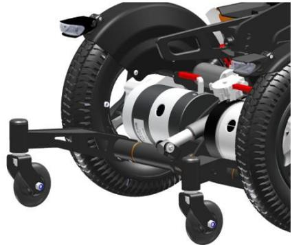
Die Stützräder verhindern das Umkippen des Rollstuhls beim Fahren, wenn er in die senkrechte Position gebracht wird. Die Stützräder befinden sich vor den Vorderrädern und werden von der Elektronik automatisch aktiviert. Die Stützräder sind in Kombination mit einem Benutzergewicht von kg40 erforderlich.
