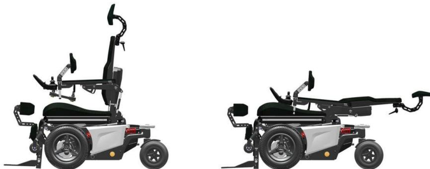
Bei einer zurückgelehnten Rückenlehnenposition über 135° wird die Fahrgeschwindigkeit aus Sicherheitsgründen automatisch reduziert.
