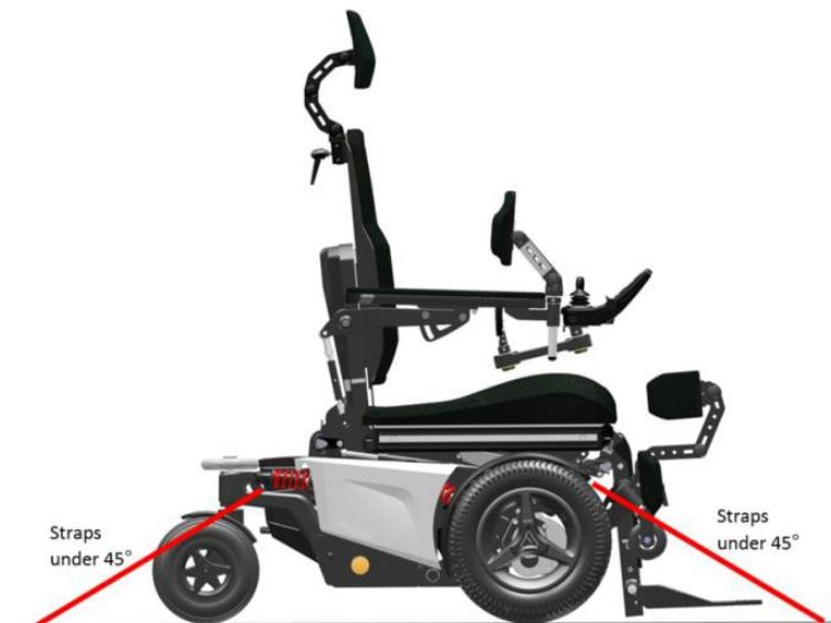
Die Gurte müssen an geeigneten Verankerungspunkten mit dem Fahrzeug verbunden sein. Stellen Sie sicher, dass der Reifendruck dem empfohlenen Wert entspricht, damit die Gurte ihre maximale Wirkung entfalten können. Achten Sie darauf, dass die Gurte fest angezogen sind, um eine optimale Sicherheit zu gewährleisten.
