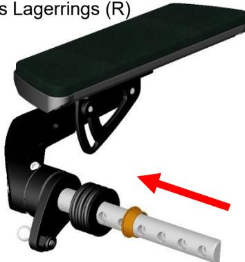
Schritt 7: Fügen Sie das Distanzstück der Achse hinzu oder entfernen Sie es und setzen Sie das Lager wieder ein.
