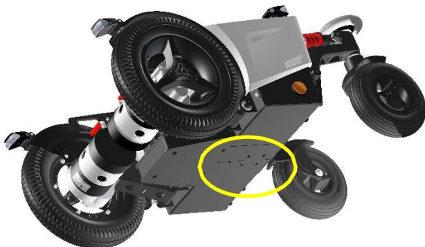
*spezielle Löcher für die Montage der Dahl Dockingplatte*
