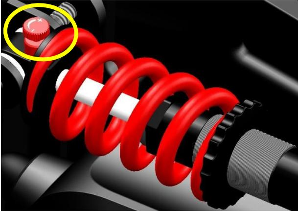
Durch Drehen des roten Knopfes im Uhrzeigersinn wird die Bewegung des Kolbens wieder schneller ausgelöst. Dadurch wird die Dämpfung der Federdämpfereinheit verringert.
