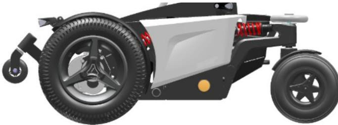
Jedes der Vorderräder wird von einem leistungsstarken Antriebsmotor angetrieben. Diese Motoren sorgen auch für die Lenkung des Rollstuhls. Mit diesem System ist es möglich, auf der Stelle zu drehen. Das macht den Rollstuhl optimal für den Einsatz in Innenräumen.
