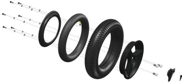
Nachdem die Räder des Rollstuhls abgenommen wurden, kann die Felge geteilt werden. Der Reifen ist dann für die Reparatur verfügbar. Die Schläuche der Reifen können entsprechend der Beschreibung auf dem von Ihnen verwendeten Reifenreparaturset repariert werden. Es wird jedoch empfohlen, den Schlauch immer zu erneuern, wenn der Schlauch eine Panne hat.
