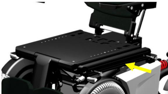
Schritt 4: Bringen Sie die Verlängerungsschiene in Position und setzen Sie die längere Befestigungsschraube ein, die mit der Verlängerungsschiene geliefert wird.
