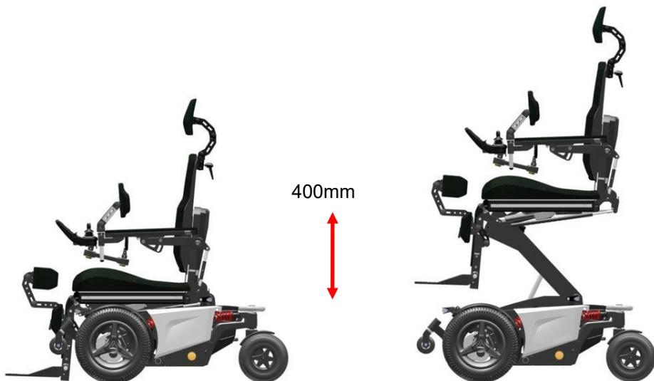
Beim Anheben des Sitzes wird die Fahrgeschwindigkeit automatisch reduziert, um jederzeit maximale Stabilität zu erreichen. Bei hoher Sitzposition wird auch die Sitzneigung blockiert, um maximale Stabilität zu erreichen. Die Sitzhöhe kann vom Benutzer in jeder Höhenposition eingestellt werden. Die maximale Sitzhöhe ist auf 950 mm eingestellt (Sitzschale zum Boden).
