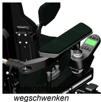
Der EVO Altus-Rollstuhl verfügt über eine Seitensteuerungseinheit, die entweder an der linken oder rechten Armlehne montiert wird. Das Joystick-Modul kann an einer festen Halterung oder an einem (optionalen) Schwenkmechanismus montiert werden. Dieses System ermöglicht es Ihnen, nahe an einem Tisch zu sitzen.
