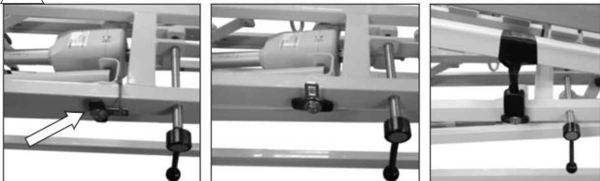
Abbildung 12: Vorgehen beim Sichern der Liegefläche gegen Hochklappen
