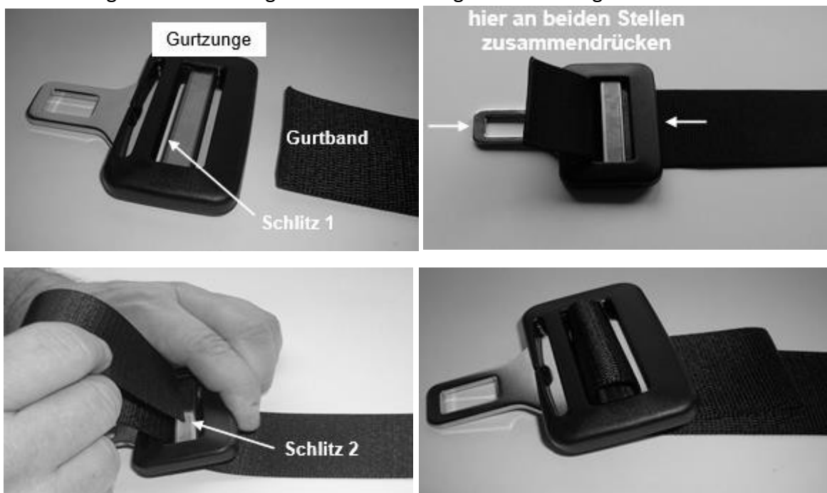
Figura 7: Procedura per l'avvolgimento della fettuccia
