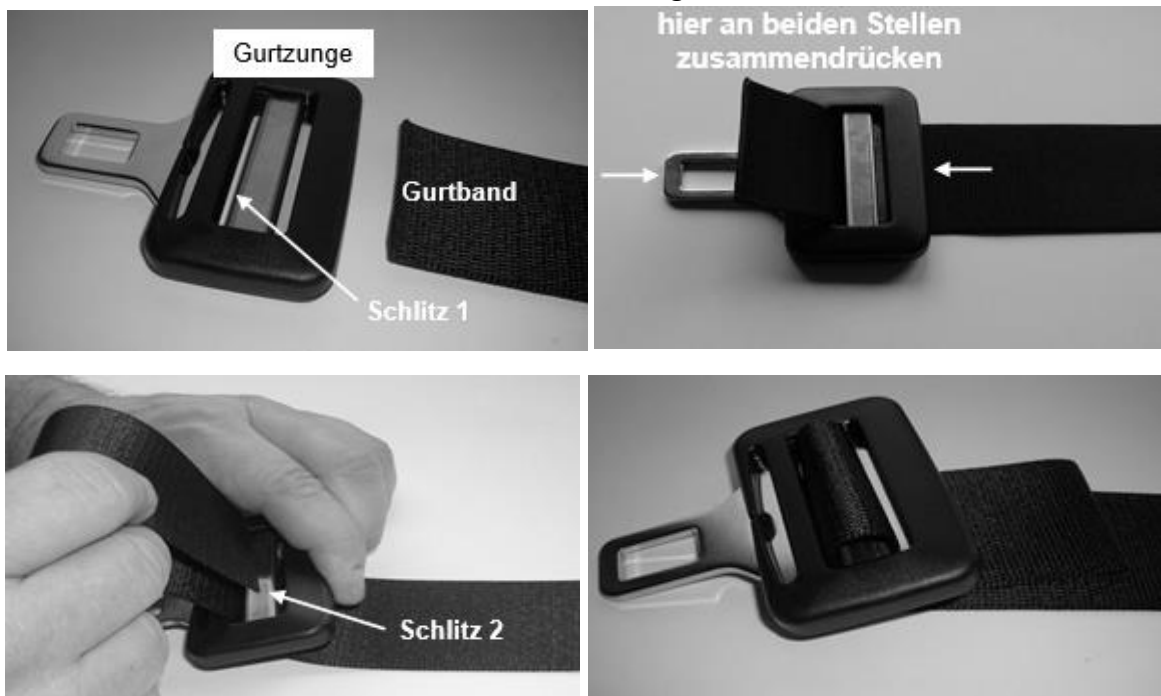
Abbildung 7: Vorgehen beim Einschlaufen des Gurtbands
