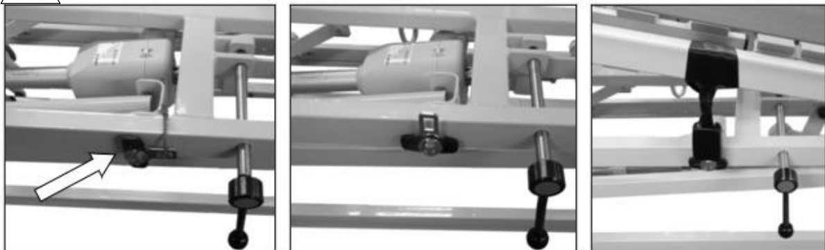
Figura 12: Procedura per fissare la superficie di appoggio contro il ribaltamento
