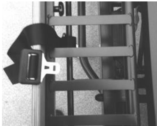
Illustration 6 : Passage de la boucle de la ceinture à travers le cadre du lit
