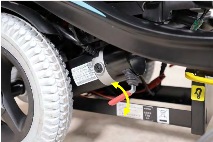
Prüfung der Bremslüftung
