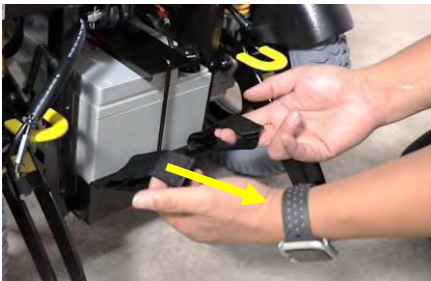
Schritt 9. Ziehen Sie die Batterieplatte mit dem hinteren und vorderen Gurt heraus
