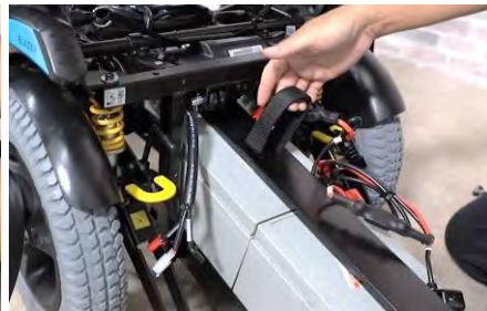
Schritt 9. Ziehen Sie die Batterieplatte mit dem hinteren und vorderen Gurt heraus
