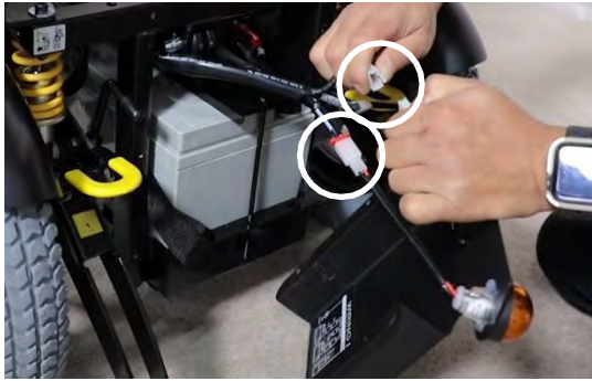
Schritt 8. Trennen Sie die beiden Lichtkabel
