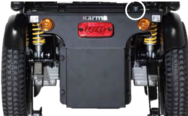
Standort des Leistungsschalters
