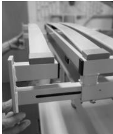
Illustration 7 : Montage de la traverse de pied (longueur du plan de couchage 220 cm)
