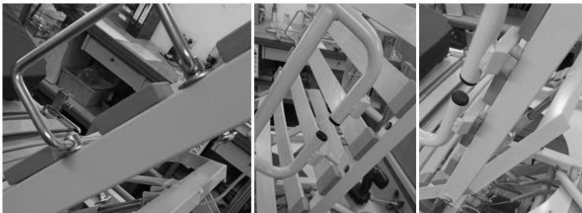
Figure 9 : Ordre de montage de l'accès au lieu de l'étrier de maintien du matelas
