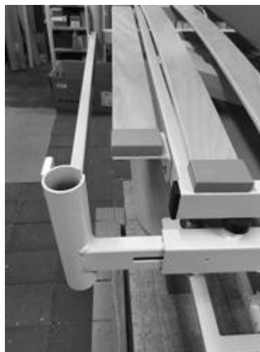
Figura 8: Montaggio della guida per la testa (lunghezza della base del materasso 220 cm)
