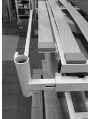
Abbildung 8: Montage der Kopftraverse (220 cm Liegeflächenlänge)
