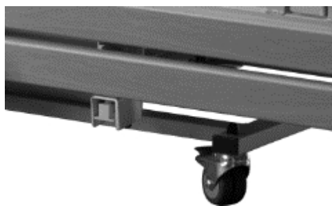
Figura 14: Pulsante/interruttore di limite premuto a causa dell'abbassamento della guida laterale
