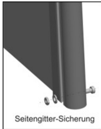
Figura 4: Fissaggio della guida laterale - come battuta inferiore per le guide laterali in legno
