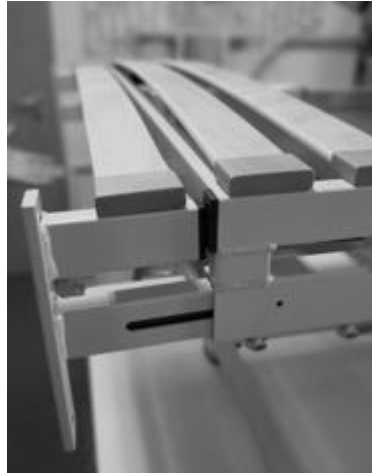
Abbildung 6: Montage der Fußtraverse (210 cm Liegeflächenlänge)
