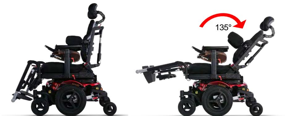
Lorsque le dossier est incliné à plus de 135°, la vitesse de conduite est automatiquement réduite pour des raisons de sécurité.
