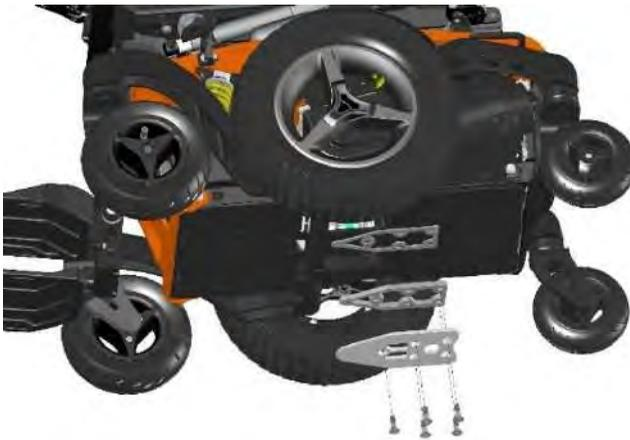
*Montage de la plaque de verrouillage Dahl sur le châssis MID*
