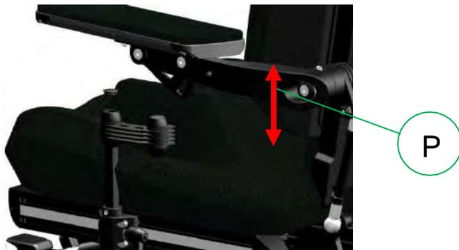
étape 4 : Retirer les couvercles en caoutchouc (P) des joints de frottement.
