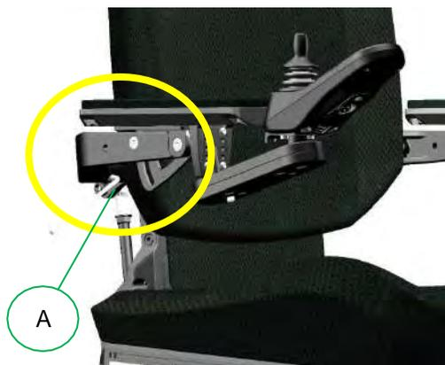
étape 1 : Débloquez les boulons de verrouillage (A) de chaque côté de l'accoudoir à l'aide d'une clé Allen de 5 mm.
