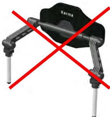
Pendant le transport en position occupée (utilisateur dans le fauteuil roulant) dans un véhicule, la genouillère doit être retirée du fauteuil roulant. Ceci afin d'éviter le risque de dommages corporels lors d'un impact. Lors d'un éventuel choc dans un accident de voiture, les jambes s'étirent vers l'avant sous l'effet de la force de réaction de l'impact. En retirant la genouillère, les jambes ne seront pas entravées.
