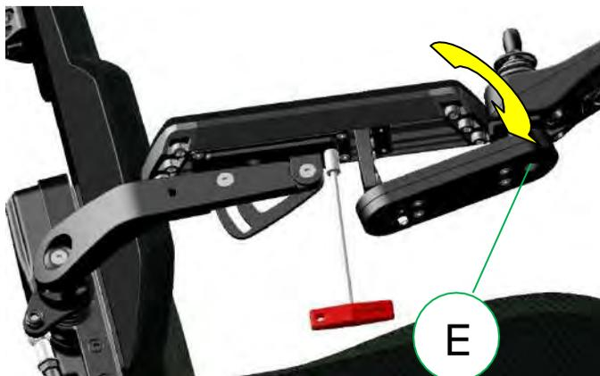
étape 1 : Desserrer l'écrou (E) sous le coussin de l'accoudoir à l'aide d'une clé de 10 mm.
