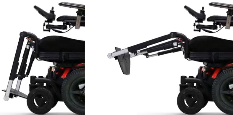
Si le repose-jambes est étiré à plus de 45°, la vitesse de conduite sera automatiquement réduite pour des raisons de sécurité.
