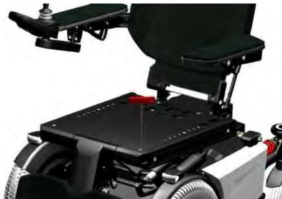
étape 9 : Remettez le panneau supérieur du siège en place et serrez les vis. Le coussin du siège peut maintenant être remis en place.
