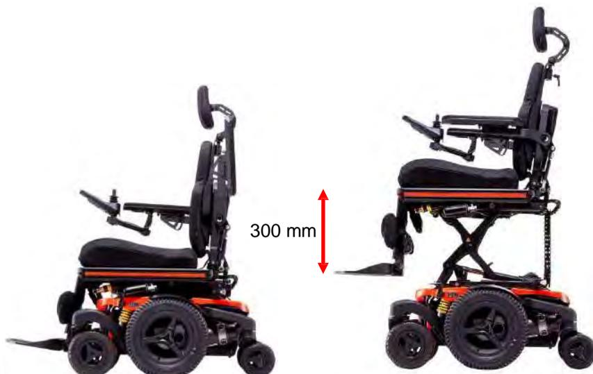
Lorsque le siège est soulevé, la vitesse de conduite est automatiquement réduite afin d'obtenir une stabilité maximale à tout moment. En position assise haute, l'inclinaison du siège est également bloquée afin d'obtenir une stabilité maximale. L'utilisateur peut régler la hauteur du siège dans toutes les positions. La hauteur maximale du siège est fixée à 760 mm (plateau du siège au sol).
