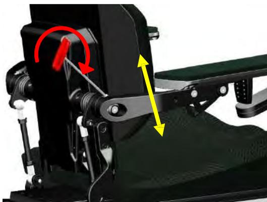
étape 2 : Réglez l'angle de l'accoudoir à l'aide d'une clé Allen de 5 mm. En la tournant dans le sens des aiguilles d'une montre, la hauteur de l'accoudoir augmente. En la tournant dans le sens inverse des aiguilles d'une montre, la hauteur de l'accoudoir sera réduite.
