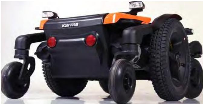
Chacune des roues motrices est propulsée par un puissant moteur d'entraînement. Ces moteurs assurent également la direction du fauteuil roulant. Grâce à ce système, il est possible de tourner sur place. Le fauteuil roulant est donc idéal pour une utilisation à l'intérieur.
