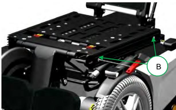
étape 4 : Desserrez les vis (B) des rails latéraux à l'aide d'une clé Allen de 4 mm.
