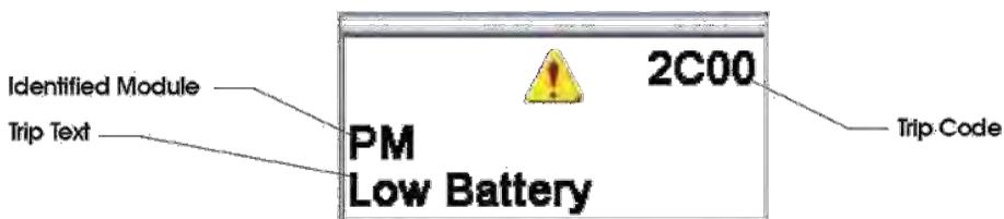
Cela indique une défaillance du système, c'est-à-dire que le R-net a détecté un problème quelque part dans le système.
