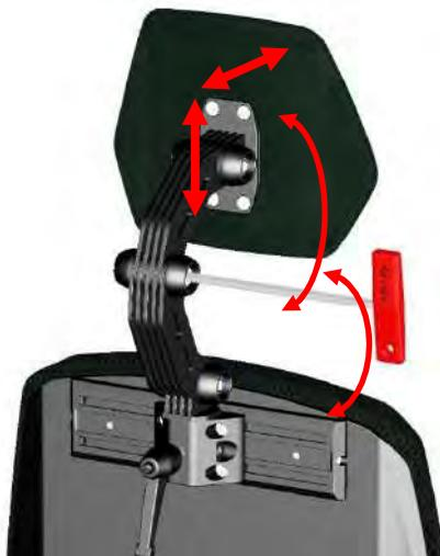
étape 2 : Desserrer les boulons à l'aide d'une clé Allen de 6 mm. Desserrez-les jusqu'à ce que l'appui-tête puisse être déplacé.
