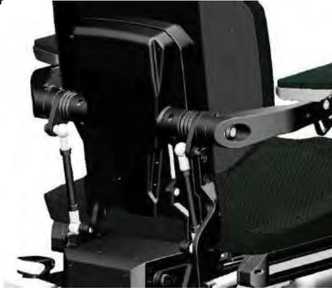
étape 9 : Connectez les deux barres parallèles et fixez-les à l'aide de la goupille de verrouillage. étape 10 : Replacez la toile du dossier sur le cadre.
