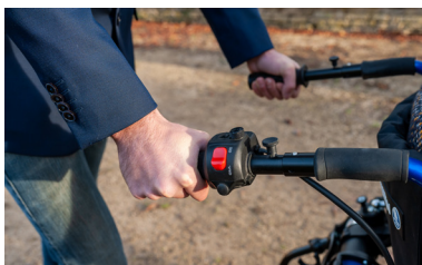
Der Gasgriff montiert
